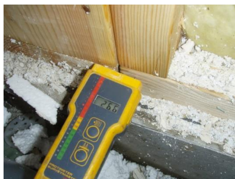
Figur 1. Fuktkvotsmätning. Till vänster med hammarelektrod. Till höger med stift på instrument.
