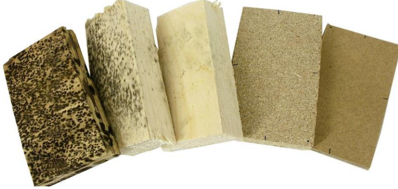
Figur 2. Fotografi på mögelprover. Mikrobiell påväxt syns inte alltid med blotta ögat. Proverna på fotot har alla mikrobiell påväxt med samma omfattning.
