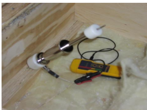
Figur 1. Fuktkvotsmätning. Till vänster med hammarelektrod. Till höger med stift på instrument.
